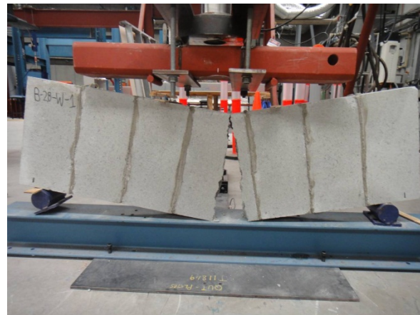
(d) Beam (block failure)
