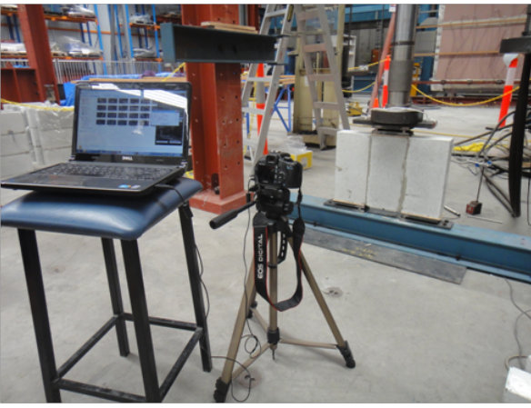
(d) Image acquiring of triplet test
