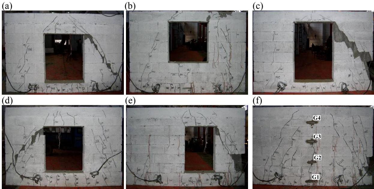
**Figure 3: Crack Patterns: a) WB1; b) WB2; c) WB3; d) WB4; e) WB5; f) WB6**
